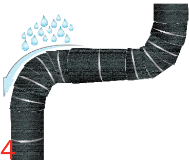
4 重叠可避免雨水穿透接头
